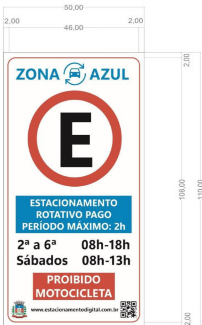
FIGURA 4.9 – MEDIDAS DA PLACA DE ESTACIONAMENTO ROTATIVO
